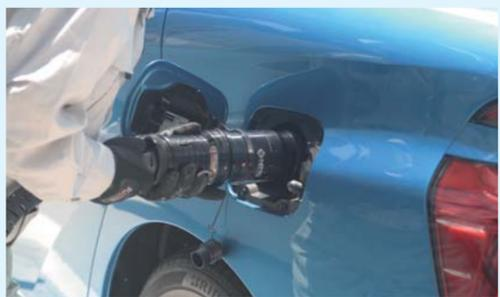
その水素と空気中の酸素を反応させて、かつて理科の実験でやった「電気分解」の逆の作用によって電気と水を生成するのだ。だから電気自動車の電気を「水素」という形で搭載するのが燃料電池車だと考えればわかりやすいと思う。
